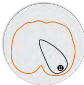
Attēls 4. R350 2.4GHz Elevation Antenna Patterns
