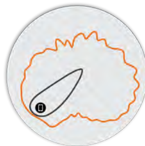
Attēls 5. R350 5GHz Elevation Antenna Patterns
