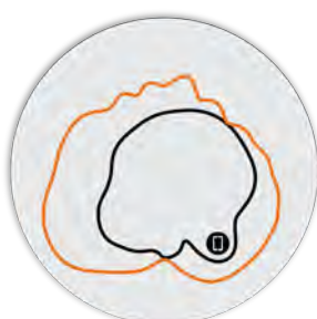
Attēls 3. R350 5GHz AzimuthAntenna Patterns
